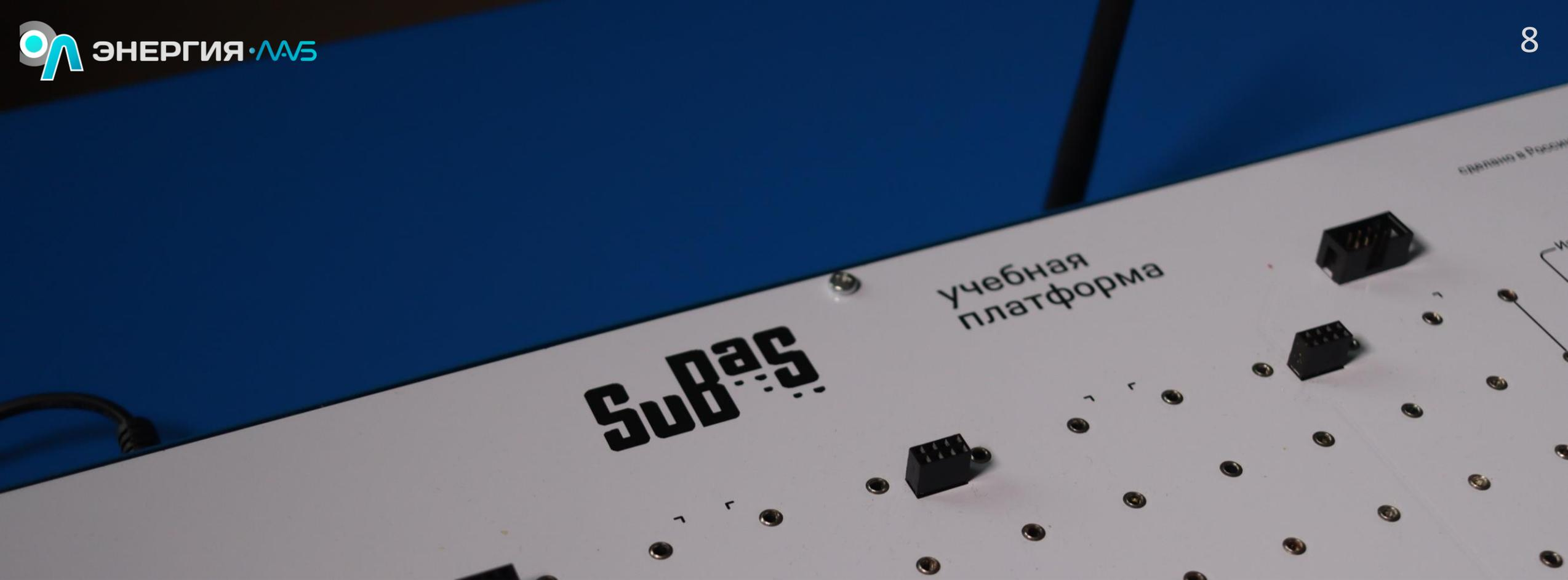
На наборном поле платформы можно составлять различные исследуемые схемы как из модулей, предоставляемых нашей компанией, так и из собственных элементов, используя безопасную макетную плату. Наборное поле содержит встроенные разъемы питания для модулей.
