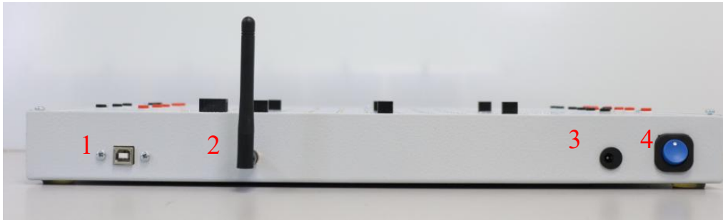
Рис. 1.2 Вид задней панели учебной платформы SuBaS. Здесь цифрами красного цвета обозначены
